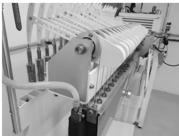
Figura 3 - Ensaio em andamento no equipamento utilizado para realização do SP – NCTL Fonte: Própria (2020)
