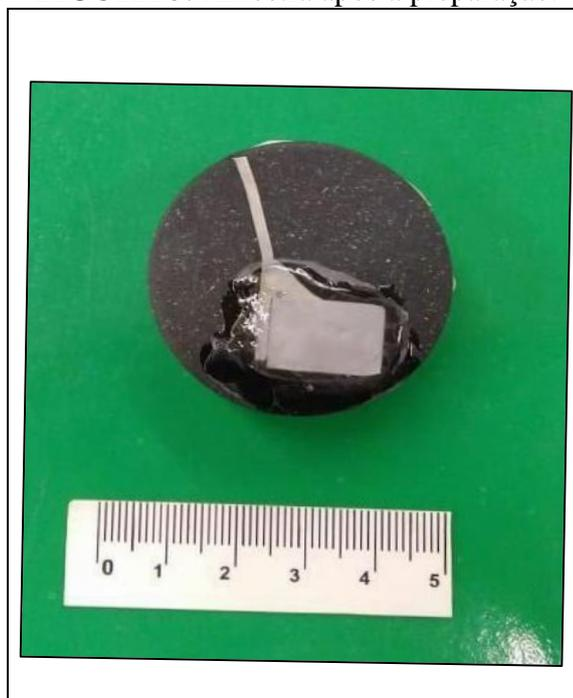
Os ensaios DL-EPR foram realizados no potenciostato/galvanostato Autolab, de acordo com a norma ASTM G108, utilizando os parâmetros velocidade de varredura de 1,67 mV/s, faixa de polarização partindo do potencial de corrosão (OCP), medido por 60 segundos, até 300
