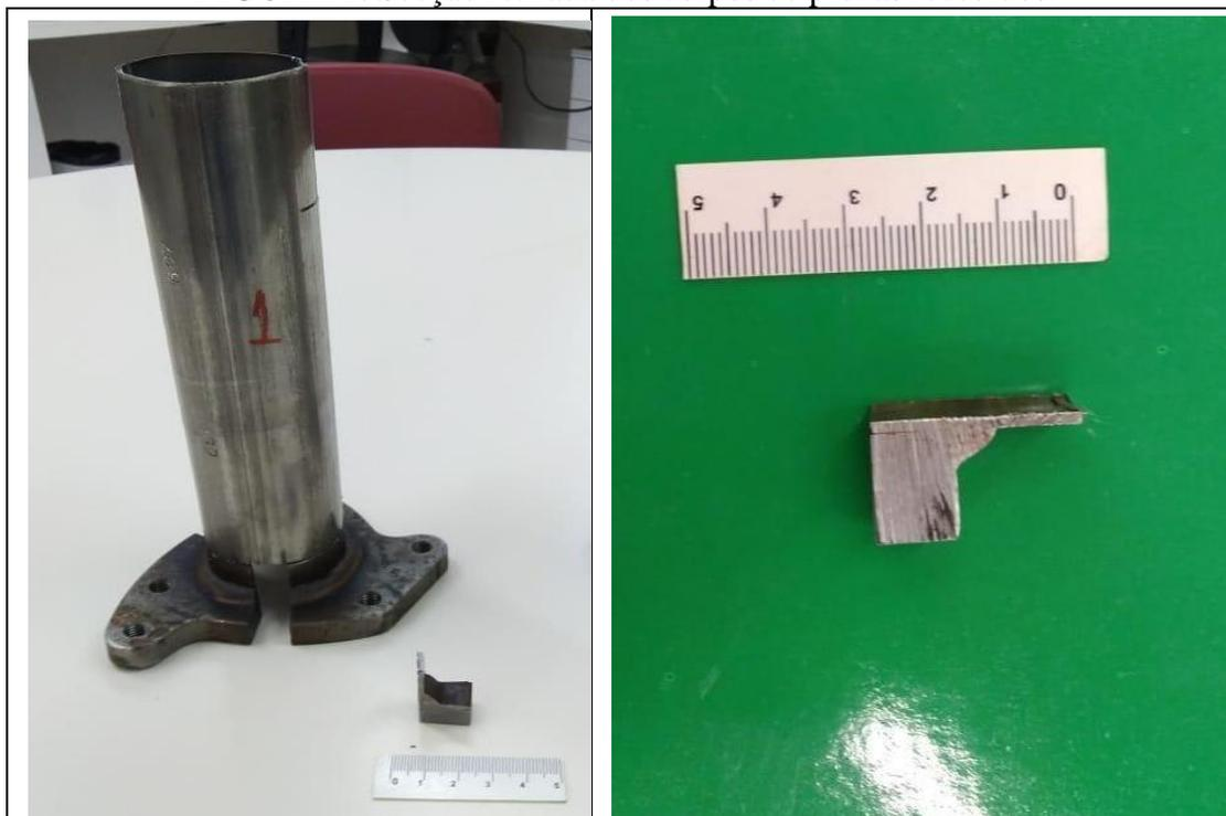
As seções obtidas foram embutidas em baquelite, identificadas e furadas para obter o contato elétrico entre o corpo de prova e a haste metálica do potenciostato, em seguida lixadas até lixa #600 e aplicada resina Araldite LY1316-2 BR com o catalisador Aradur 42 sobre a região do flange e do cordão de solda para isolar a região do inox estudado, ao final da preparação obteve-se o corpo de prova como apresentado na FIGURA 3.
