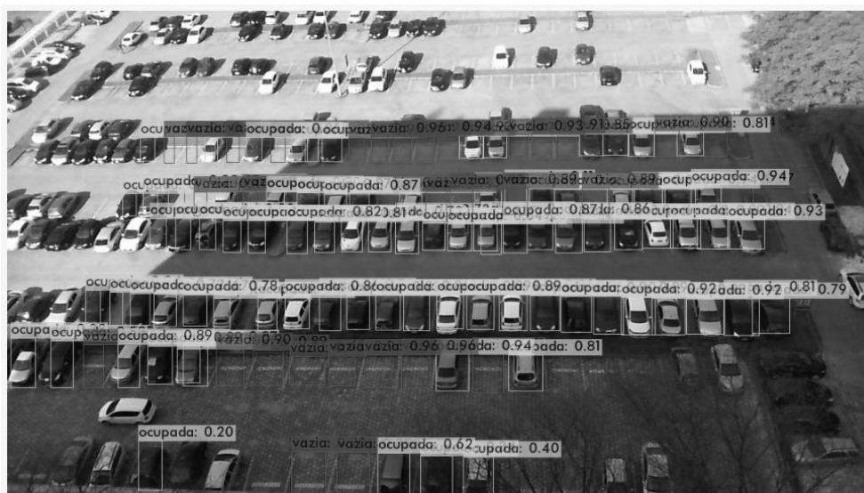
Figura 9 - Processamento de uma imagem para identificação de vagas. Fonte: o autor, com base na imagem de Almeida et al. 2015.
