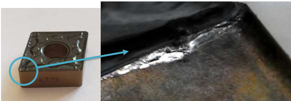
Figura 4 – Inserto novo e aresta com desgaste ( V_b=0,3 mm)
