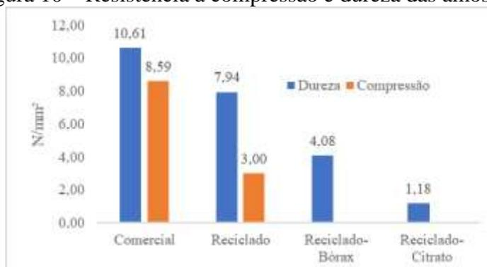
O G.C atendeu as especificações de resistência à compressão, mas não obedeceu aos critérios de dureza. Houve uma queda de qualidade após o processo de calcinação, mostrado nos valores acima. Os corpos de prova com aditivos em sua composição fraturaram durante a aplicação da carga para o ensaio de dureza, impossibilitando as leituras e o ensaio de resistência de compressão, evidenciando uma baixa resistência mecânica do produto final.
