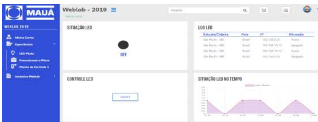
Figura 9 – Tela do projeto piloto – Experimento de controle de acionamento de LED.
