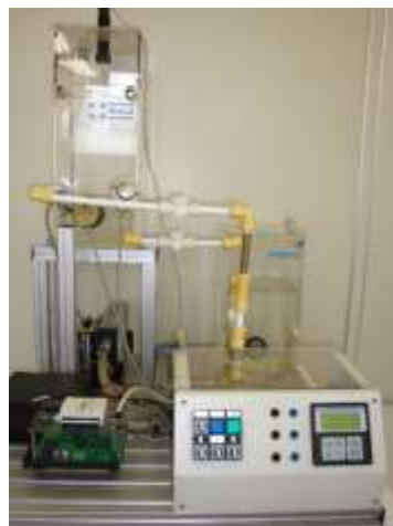
Figura 2 – Planta de controle de nível PCS Festo
