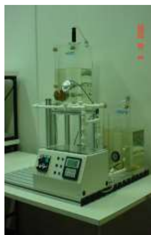
Figura 2 – Planta de controle de nível PCS Festo
