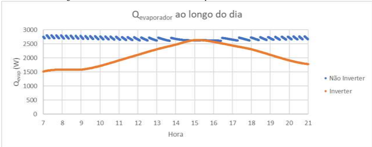
Figura 5. Perfil da taxa de calor trocado no evaporador dos condicionadores de ar.
