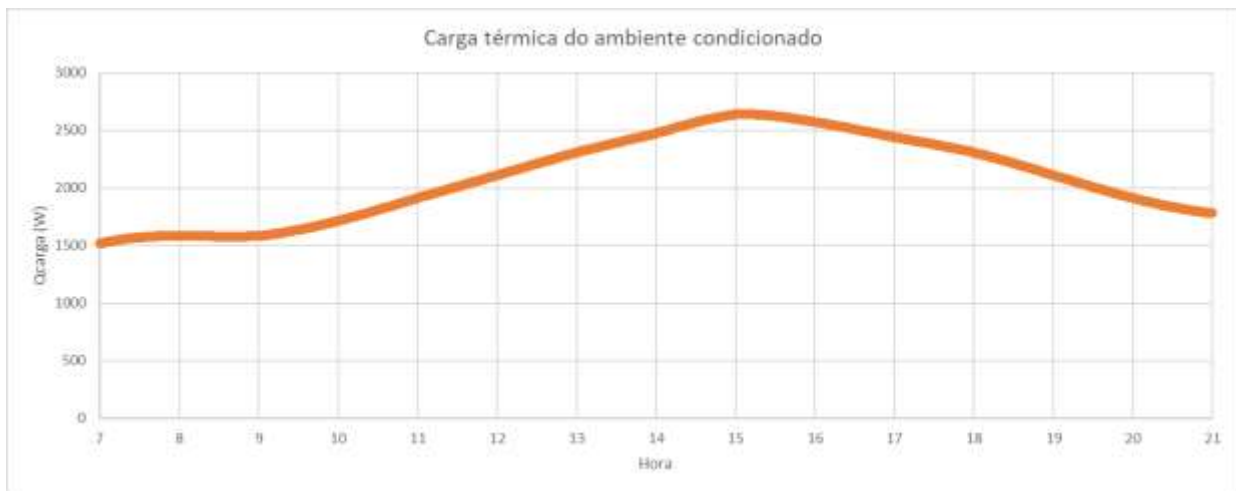
Figura 1. Perfil de carga térmica do ambiente condicionado tomado como caso de estudo.
