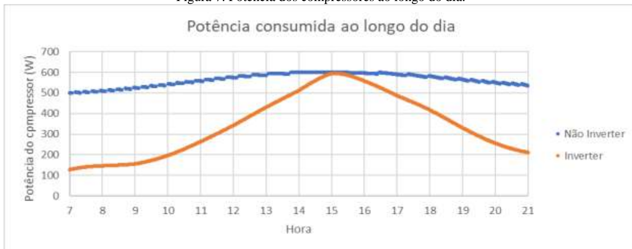
Figura 7. Potência dos compressores ao longo do dia.
