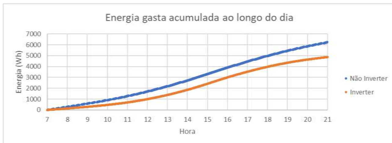
Figura 9. Consumo integralizado de energia elétrica (Wh) ao longo do dia.
