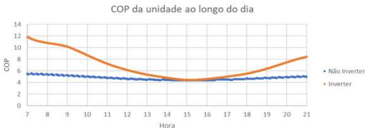
Figura 8. COP dos condicionadores ao longo do dia.
