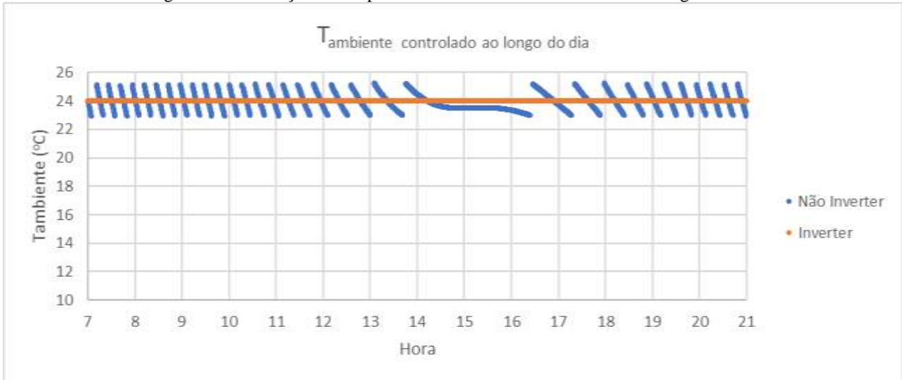
Figura 3. Distribuição de temperatura do ambiente condicionado ao longo do dia.
