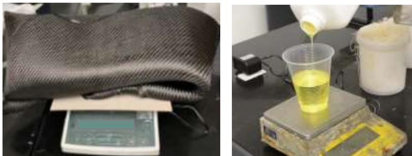
Com essa etapa inicial concluída, deu-se início a laminação do material, na qual consistiu em aplicar a matriz sobre a fibra, de forma a impregná-la, e envolver o molde com o tecido dando voltas até que o número de camadas seja o previamente estipulado.
