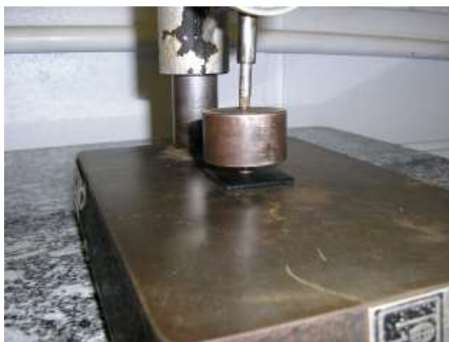
Figura 1 – Equipamento utilizado no ensaio de espessura.
