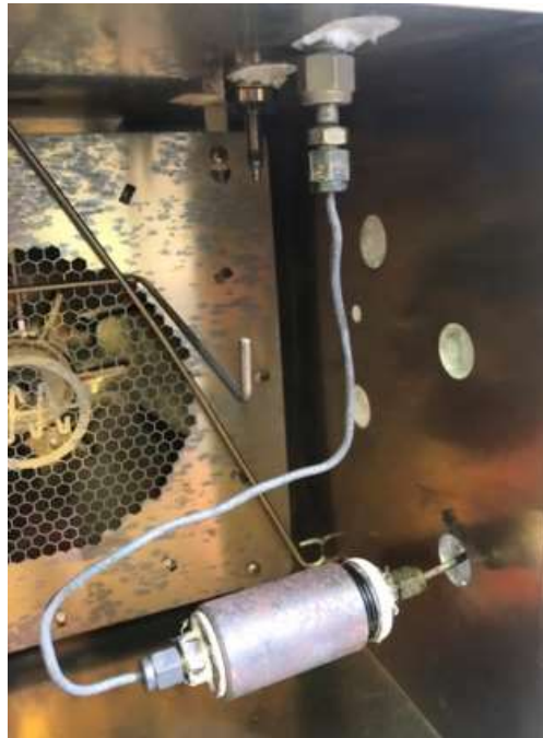
Figura 4 – Reator que permite fluxo de N 2 , dentro do forno do cromatógrafo.
