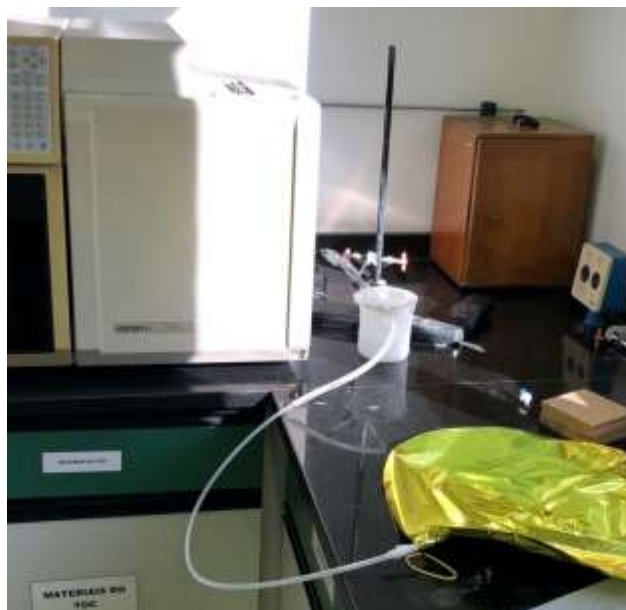
Figura 6 – Balão para coleta do gás e Béquer para coleta do precipitado acoplados à saída do reator, dentro do forno.
