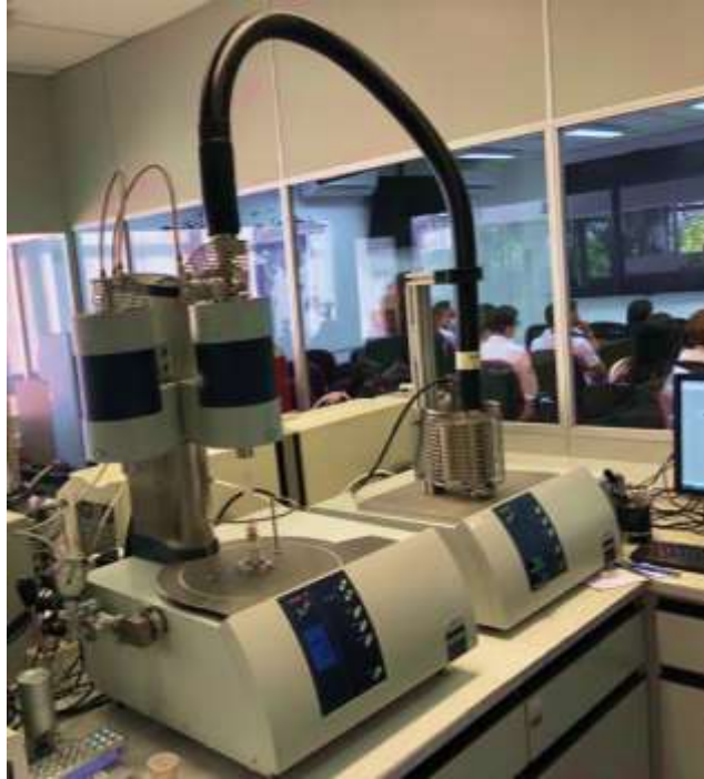
Figura 10 – TGA-MS usado na análise, presente no LAREX, Universidade de São Paulo.
