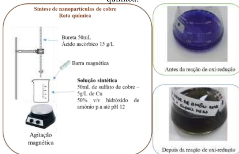
Neste ensaio adicionou-se o hidróxido de amônio até pH igual a 12 para preparar a solução de cobre 5 g/L, esta solução mudou sua coloração para um azul mais escuro, conforme Figura 4.
