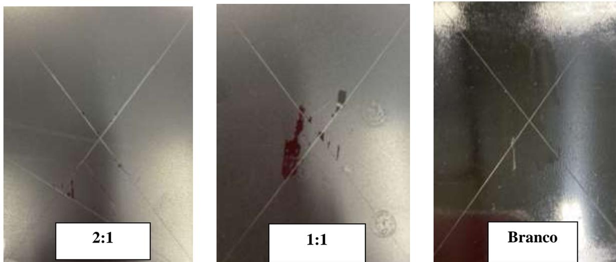
Figura 8: ensaio de aderência na placa de aço inox.
