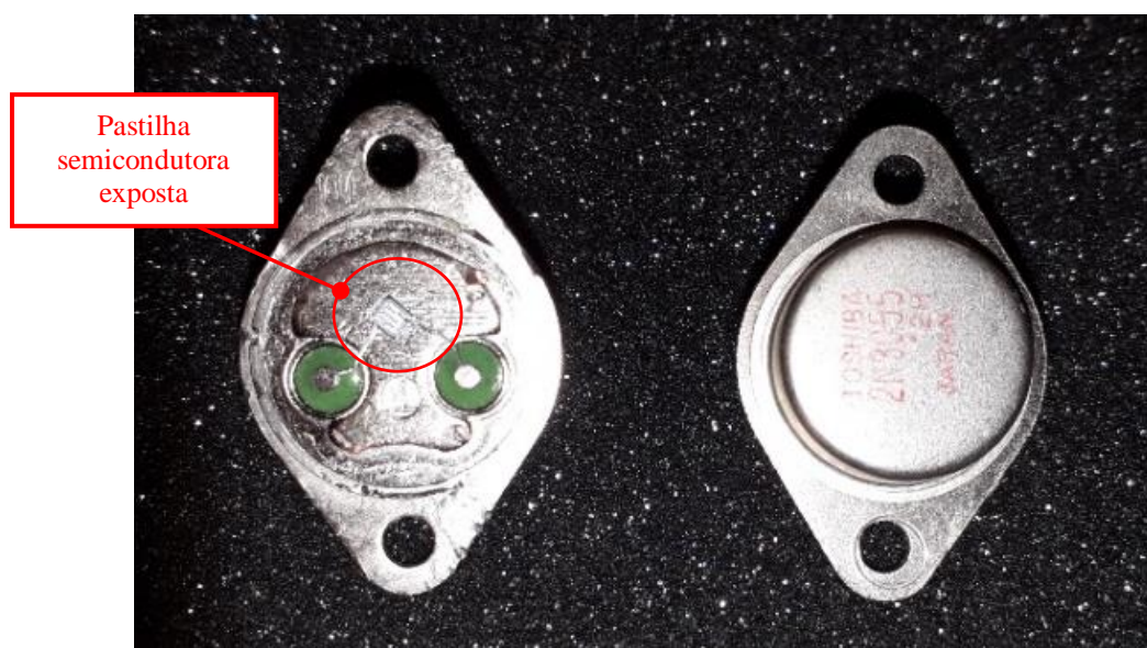
Figura 2: À esquerda, componente sem a carcaça, com o chip de silício exposto e; à direita, o componente na íntegra.
