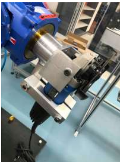
Figura 5 - Conjunto já montado no braço robótico.
