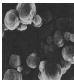
Figura 15 - MEV de amostra de ZSM-5 (Gabelica, et. al., 1983)
