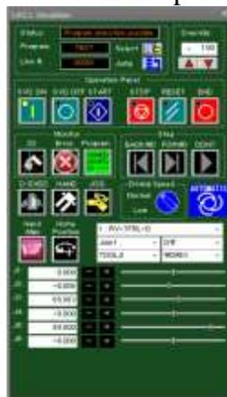
Após definir as coordenadas dos pontos, cria-se a programação com a sequência de movimentos que se deseja que o robô realize. É possível checar para ver se não há nenhum erro de nomenclatura na programação para salva-la, e também verificar interferências ou choques durante os movimentos, com os recursos do software CAD, e corrigir eventuais erros observados no ambiente virtual antes que estes causem acidentes no ambiente real.
