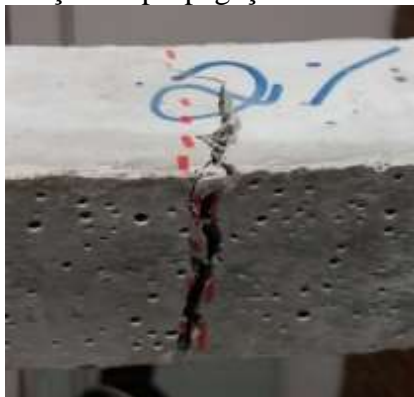
Figura 7 – Redução da propagação das fissuras pela fibra.
