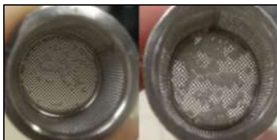
Figura 14 – Microgrânulos ao final da dissolução em pH = 1,2. À esquerda pellets de F1 e à direita pellets de F2.
