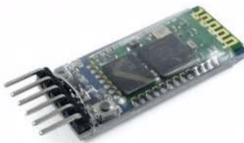
Figura 2 – Módulo Bluetooth SR232 HC-05.
