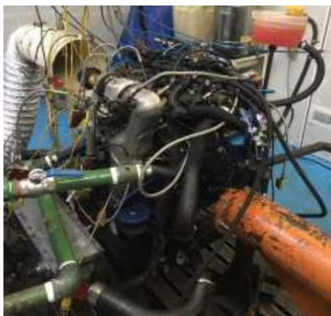
Figura 1 – Motor 1.3 Multijet instalado e instrumentado
