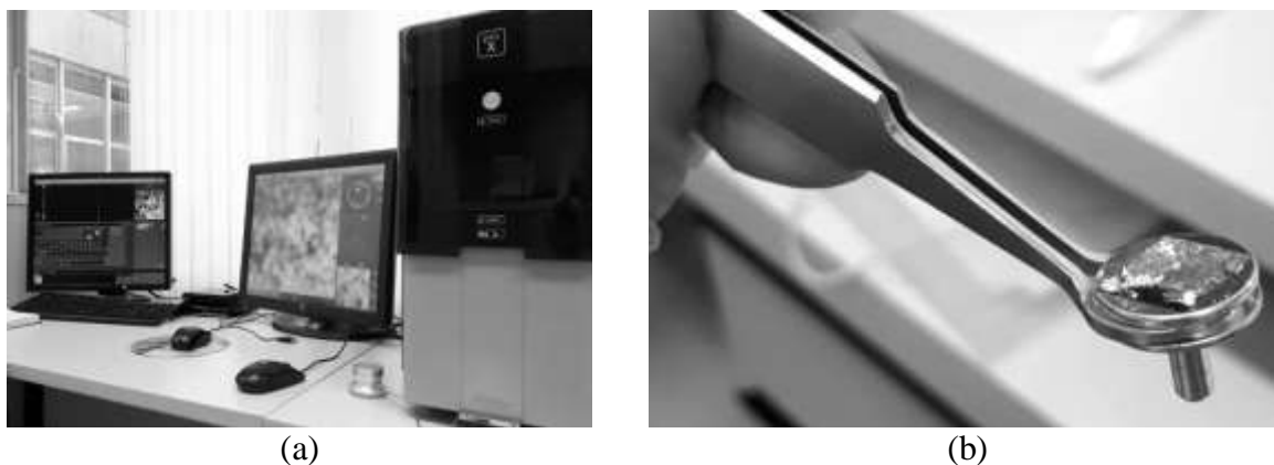
Figura 4. a) Microscópio Eletrônico de Varredura (MEV) utilizado na análise das amostras; b) Amostra em pó fixada no stub com fita de carbono.
