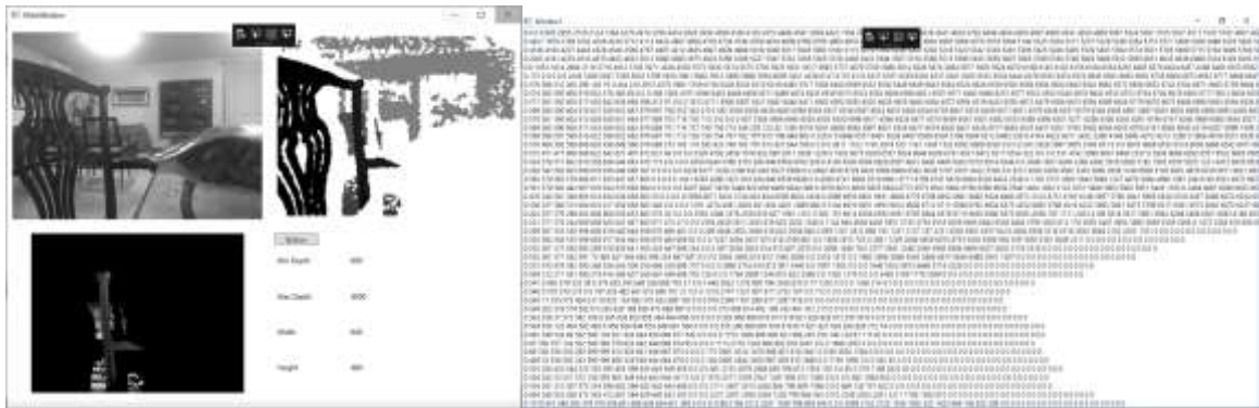
Figura 3 - Interface do programa criado para transformar distancia em arquivo texto e demonstração do arquivo
