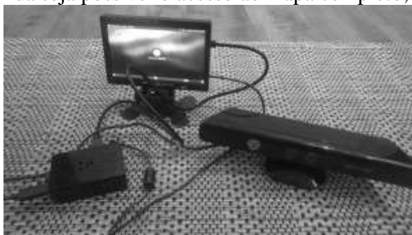
Figura 1 - Materiais conectados utilizados: Raspberry (junto com o display) e Kinect
