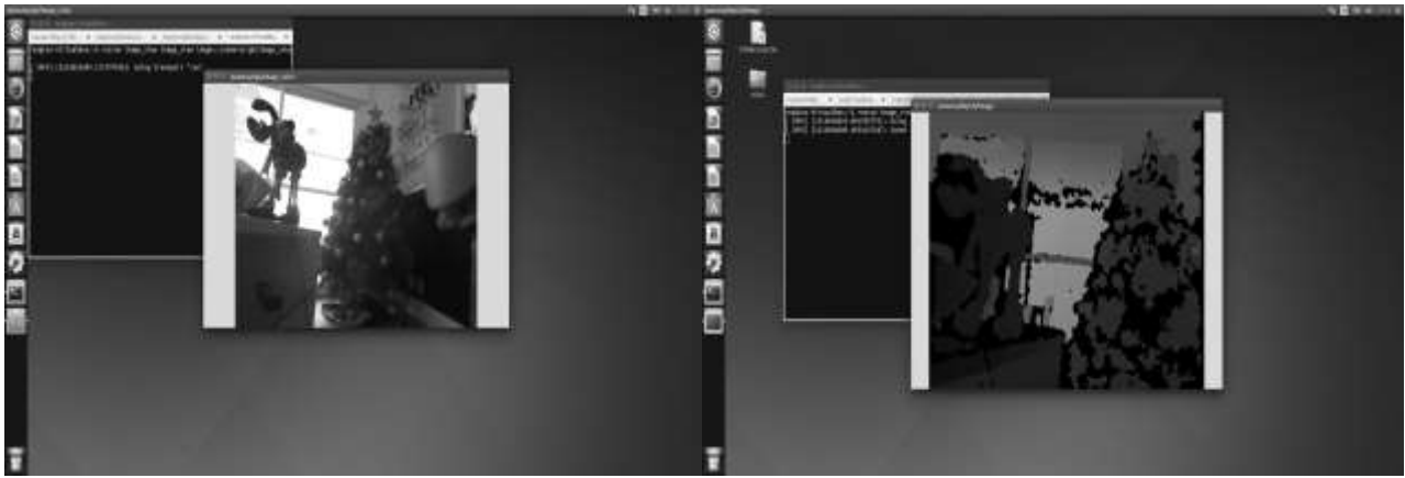
Figura 5 - Imagem RGB (esquerda) e de distância (direita) do Kinect adquirida pela conexão ROS entre Raspberry e Máquina Virtual
