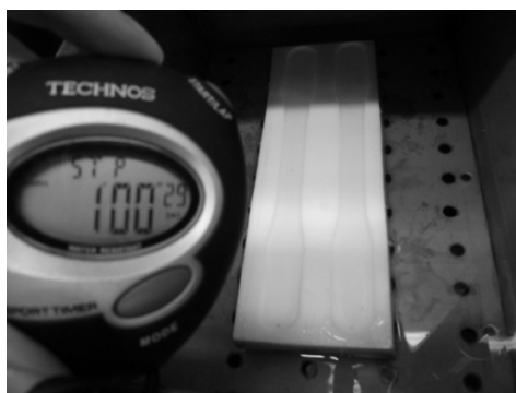
Figura 6 - Cura de resina epóxi na cavidade de corneta com misturador de módulo e carbeto de silício após primeiro 1 minuto a 500 W.
