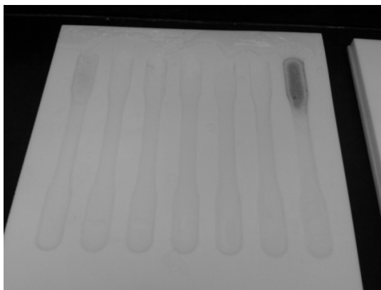
Figura 4 - Molde de teflon com resina epóxi após permanência de 2 minutos na câmara Deodato a 300 W.
