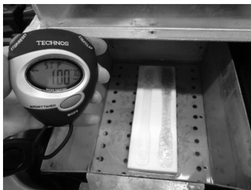
Figura 5 - Cura da resina epóxi na cavidade de corneta com misturador de módulo após primeiro 1 minuto a 500 W.
