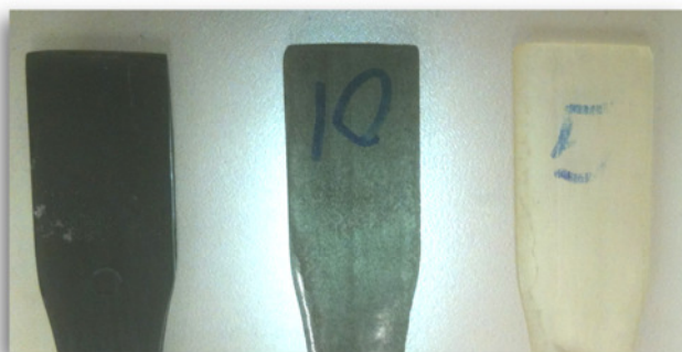
Figura 7 – Comparação entre a resina sem NTC (dir.), o compósito fabricado após a modificação no processo (esq.) e antes (centro)
