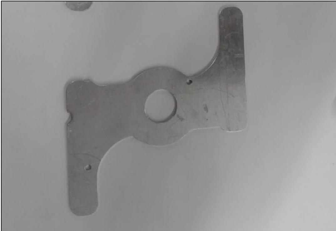
Abaixo o acoplamento que foi usinado para unir o eixo do gerador com o mancal de disco rígido.
