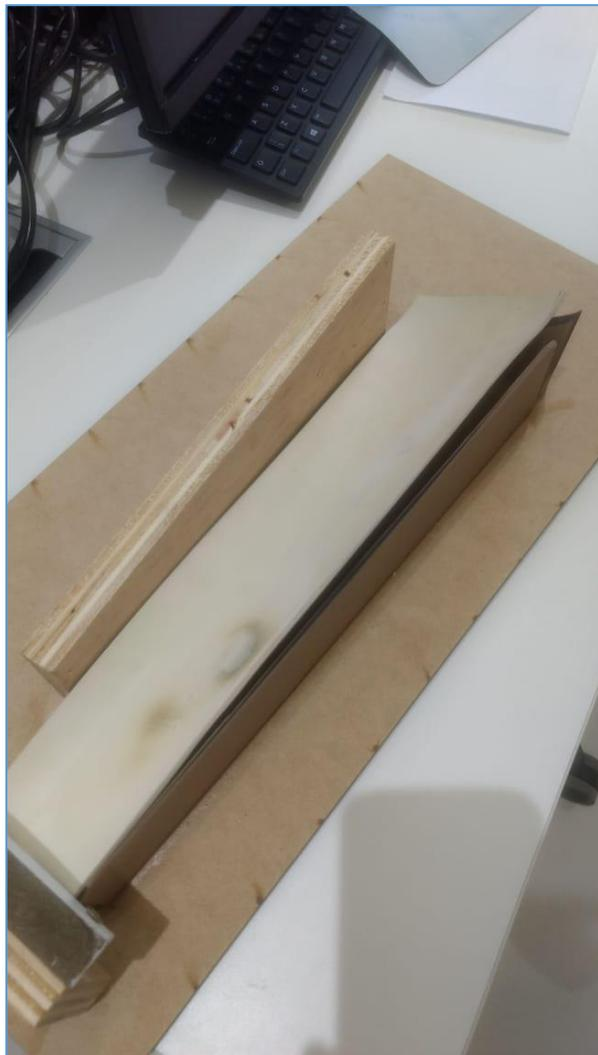
O sétimo passo está ilustrado abaixo e tem a função de completar uma pequena espessura faltante na chapa de PVC para deixar o bordo de ataque com o perfil correto, perto da raiz da pá.
