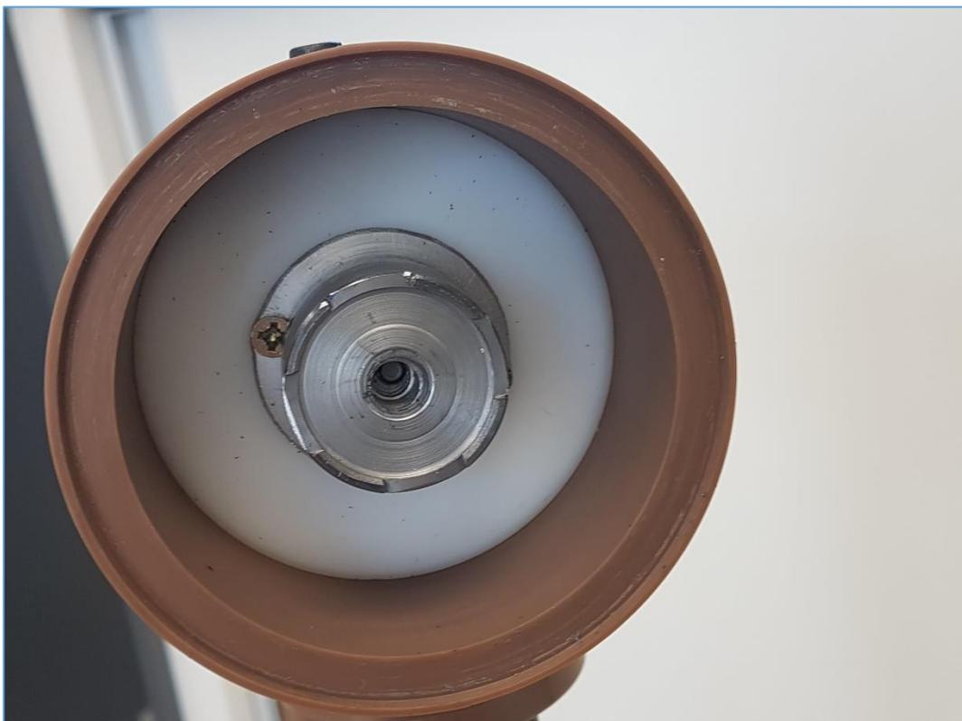
Abaixo o cubo finalizado e instalado na nacelle, sem o spinner.
