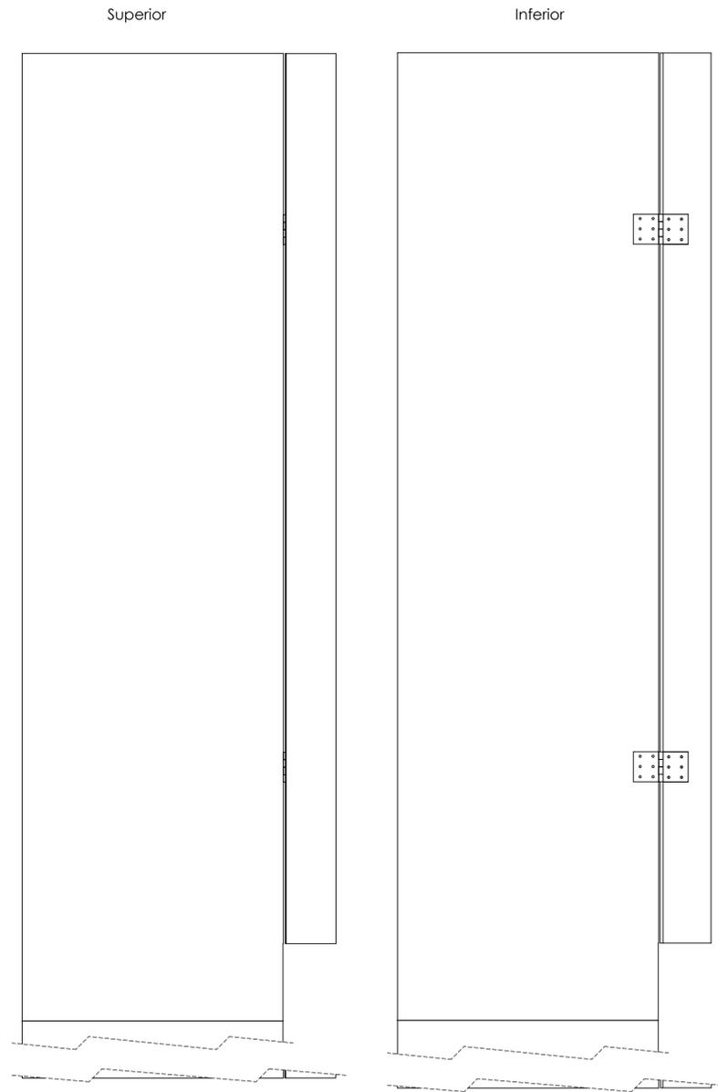
As dobradiças mostradas no desenho podem ser substituídas pela fita filamentosa ou durex
