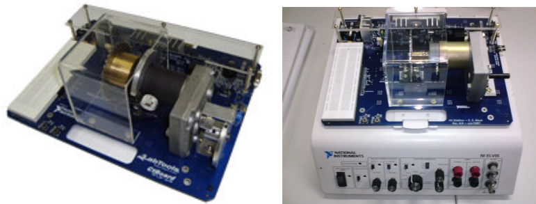
Figura 10 – CtBoard e Montagem da Placa Sobre o Kit ELVIS ®
