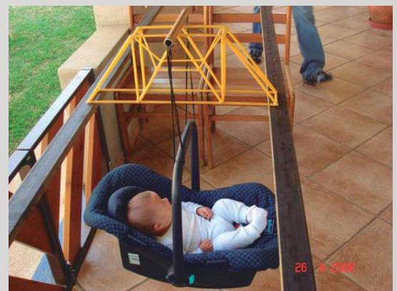
**Desafio:** Construção de uma ponte treliçada, dentro das especificações fornecidas pelo aplicador, que suporte a maior carga possível.
