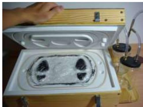
Um segundo protótipo foi desenvolvido a partir dos problemas verificados no protótipo inicial, foi modificado o processo de manufatura dos moldes superior e inferior, visando à precisão geométrica acima da menor contração da resina. Os negativos dos moldes superior e inferior foram usinados na prototipagem em RenShape 440 e sobre eles foi passada uma grossa camada de Gel Coat, e por cima foi laminado com manta de fibra de vidro e resina poliéster.
