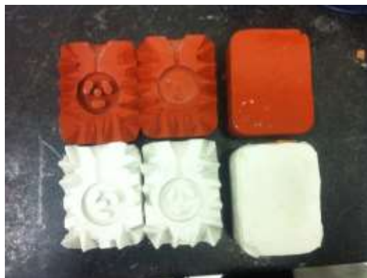
Figura 2. Moldes em silicone, acima moldagem a frio, abaixo moldagem a quente.
