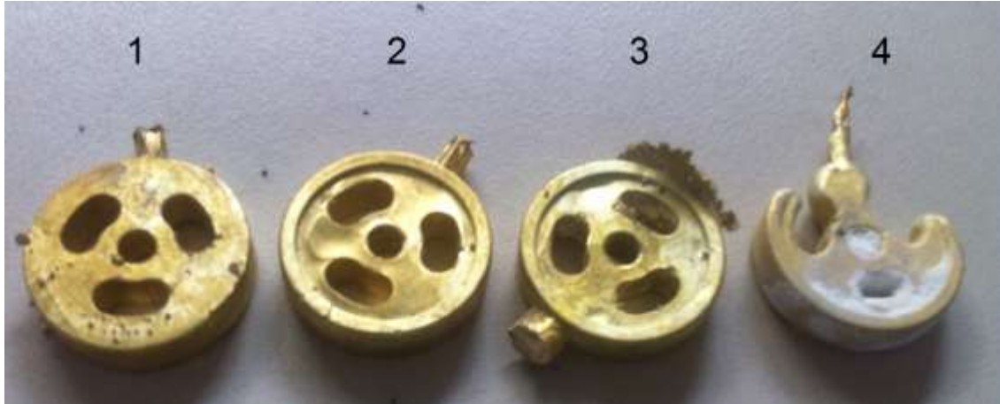
Figura 6. Defeitos em peças fundidas: 1- Bolhas; 2- Contração volumétrica; 3-Trinca no molde de gesso, ocasionando uma rebarba; 4- Não preenchimento por bolha de ar gerada durante vazamento do latão.
