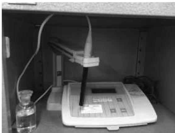
Ademais, o condutivímetro utilizado, como apresentado na Figura 1, foi zerado com água destilada até a condutividade de  $0,0 \mu\text{s}\cdot\text{cm}^{-1}$  entre cada teste conduzido, variando-se a concentração da solução.
