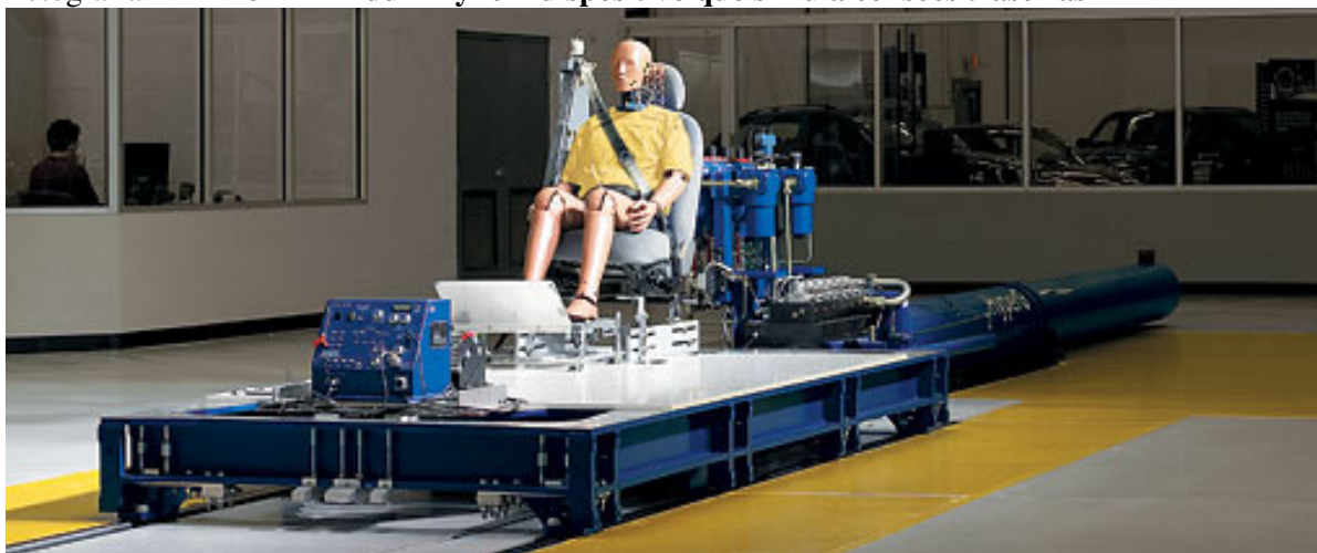
Fotografia 14 – BioRID-II dummy 1 em dispositivo que simula colisões traseiras
