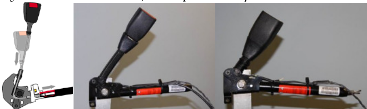
Figura 7 – Pré-tensionador no buckle, antes x depois de sua atuação.
