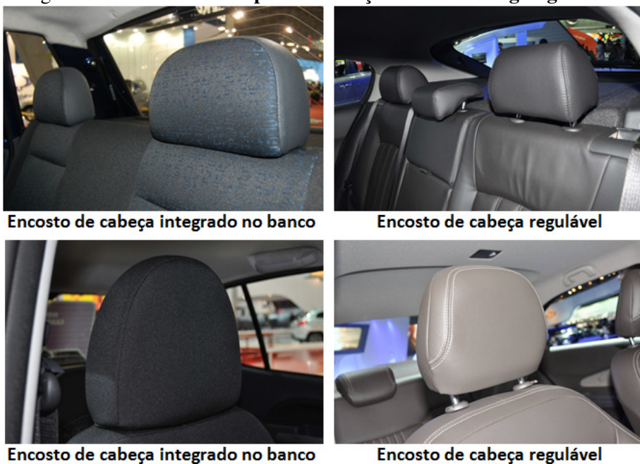
Fotografia 13 – Sistemas de apoio de cabeça fixos e com regulagem de altura
