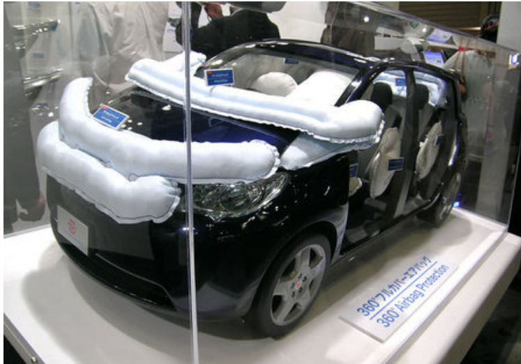
Fotografia 40 – Aplicação de diversos airbags na parte frontal do veículo.
