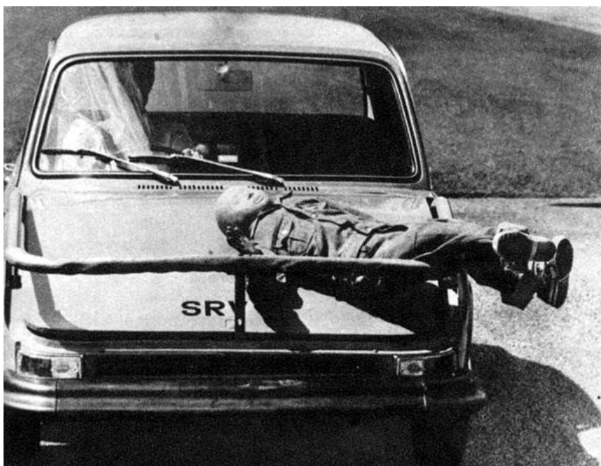
Fotografia 11 – Conceito desenvolvido para evitar rolamento do pedestre, 1974
