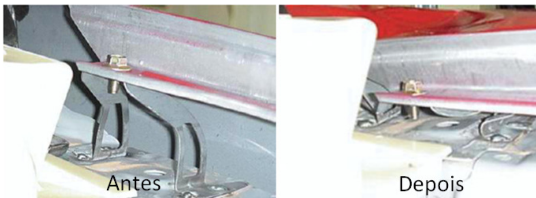
Fotografia 26 – Simulação física de uma aplicação de suporte deformável.
