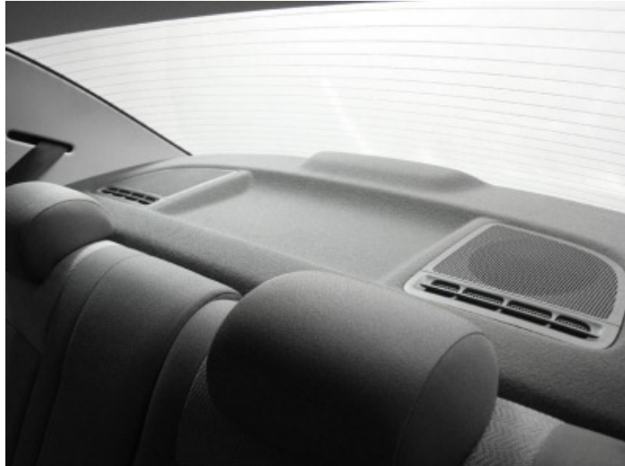
Figura 10: Exemplo de falante instalado no porta pacotes
