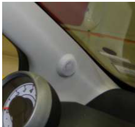
Figura 8: Exemplo de alto-falante na coluna A
