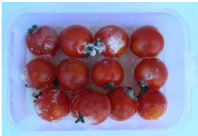
FIGURA 7 – BANDEJAS PLÁSTICAS COM NANOESFERAS DE PRATA
