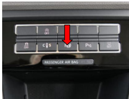
Figura 1 – Interruptor de acionamento do assistente de estacionamento. FONTE: AUTO ZEITUNG (2012).
