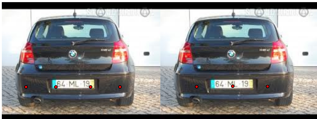
Figura 15 – Fotografia de Veículo com Otimização de 4 para 3 sensores ultrassônicos FONTE: COZOT CARROS, 2012.
