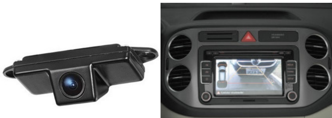
Figura 16 – Câmera traseira e display do rádio. FONTE: CARROS DA FIPE (2012) e BERNABAUER.COM (2012)
