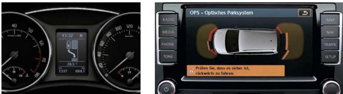
Figura 4 – Display com as informações dos passos de estacionamento (painel de instrumentos ou rádio). Fonte: ŠKODA ÖSTERREICH (2012) e LANGZEITTEST DE (2012).
