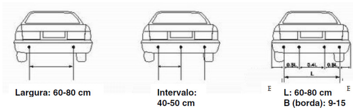
Figura 14 – Disposição dos sensores ultrassônicos no pára-choque. Fonte: SW SHOP (2012)
