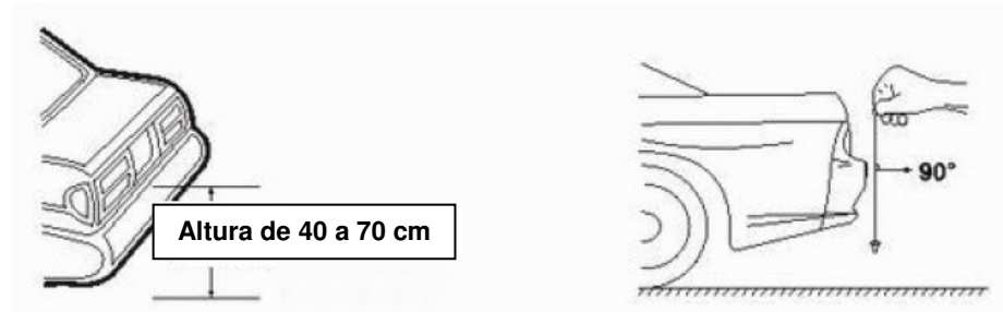
Figura 13 – Posição de instalação do sensor ultrassônico de estacionamento. : SW SHOP (2012)
