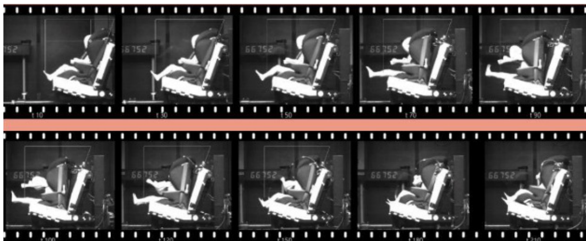
FIGURA 5 – Comportamento típico do dummy em um impacto frontal
