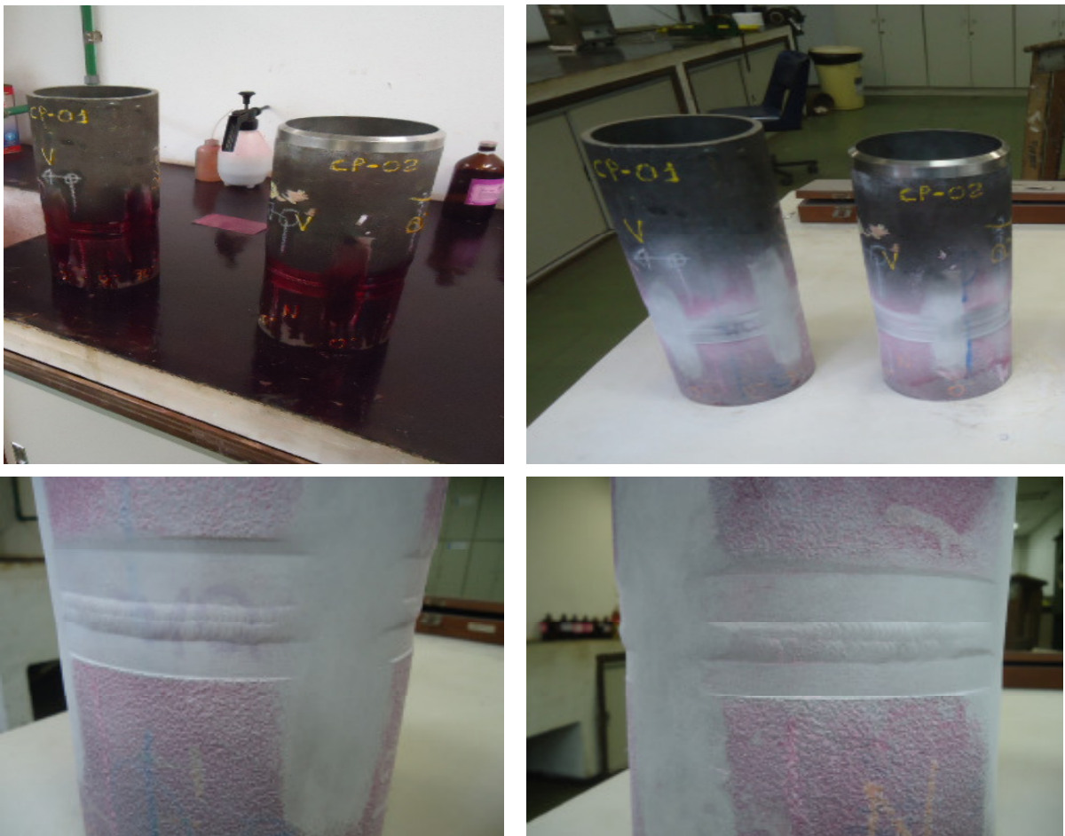
Figura 9 – Ensaio de líquido penetrante – a) penetrante CP 1 e 2; b) revelador CP 1 e 2; c e d) revelador CP 1
