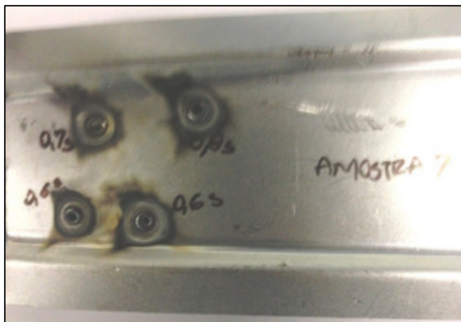
Figura 29 - Amostra 7 - soldagem com zinco
