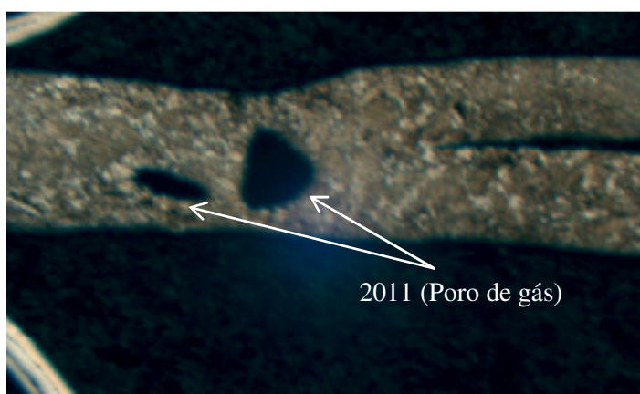
Figura 41 - Poros na zona fundida CHAPA A
