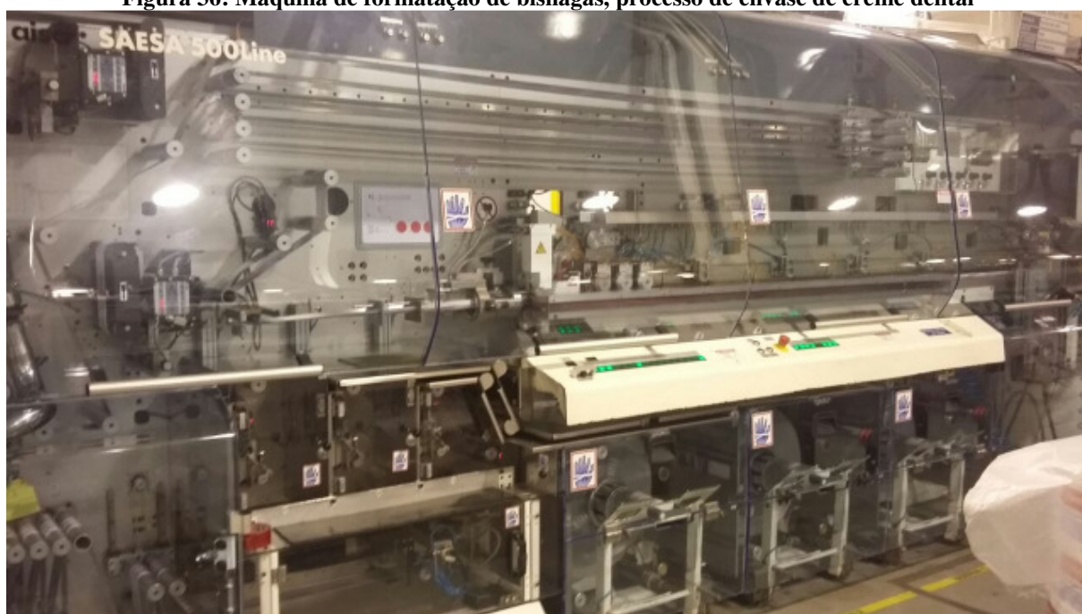
Figura 36: Máquina de formação de bisnagas, processo de envase de creme dental
