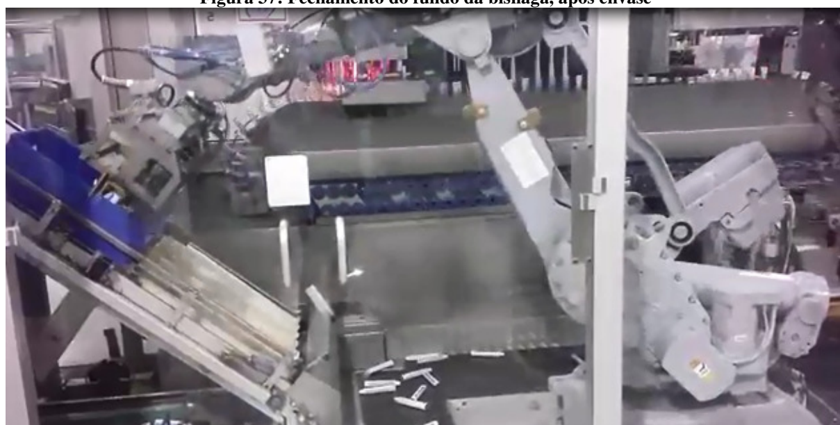
Figura 37: Fechamento do fundo da bisnaga, após envase
