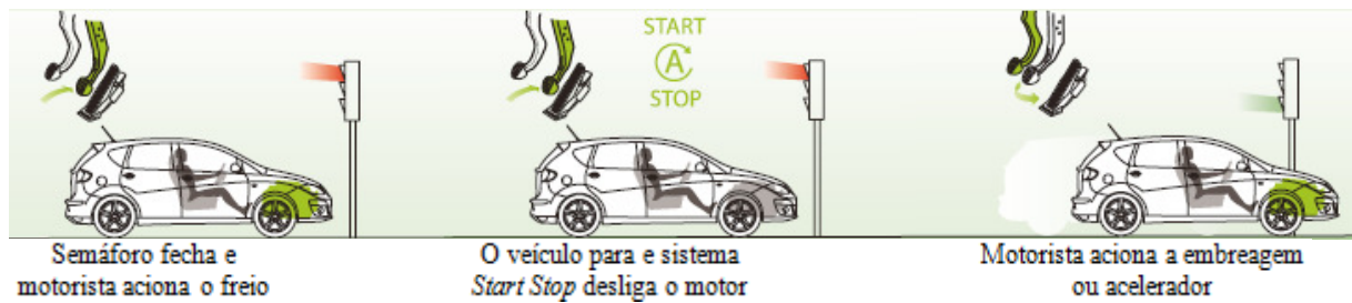
Figura 2 – Funcionamento do Sistema Start Stop
