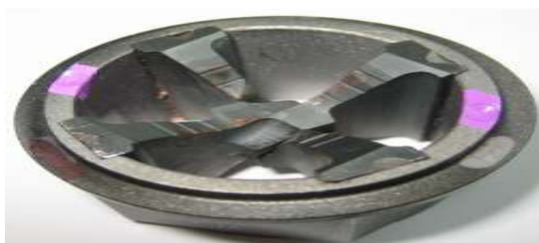
Figura 13 - Lâmina para eletrodos Semtorq sq 16-6
