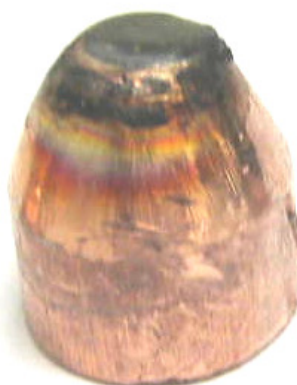
Figura 4 - Eletrodo com coloração degrade indicando refrigeração insuficiente (Tomoana GM)
