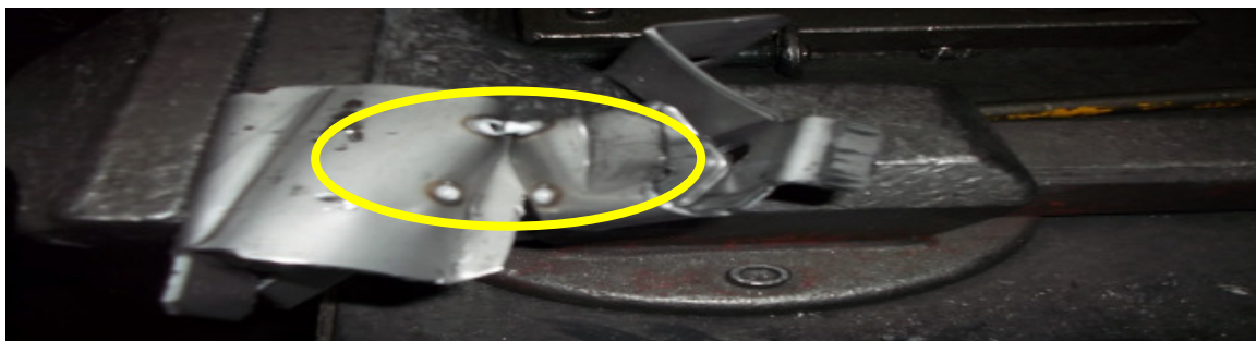
Figura 10 – Ponto sem caldeamento, feito teste destrutivo
