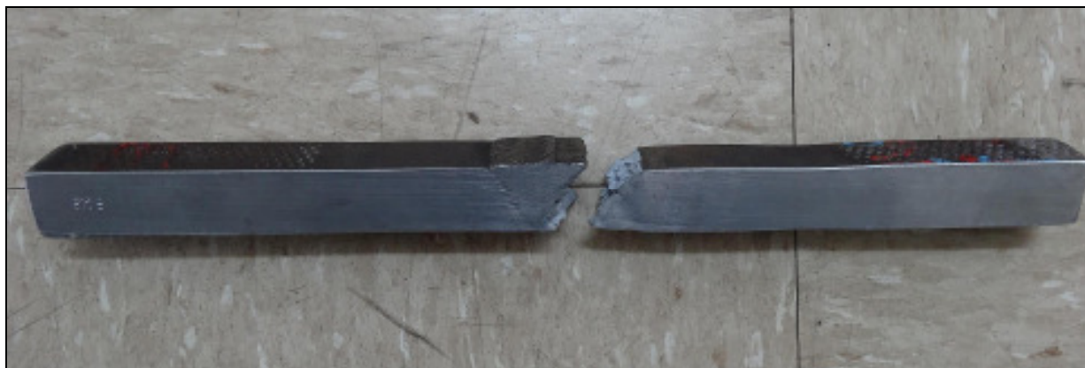
Figura 23 - Corpo de prova de tração sem pré-aquecimento, rompido na linha de fusão.
