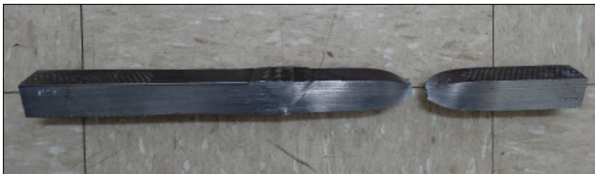
Figura 24 - Corpo de prova de tração com pré-aquecimento, rompido no metal de base
