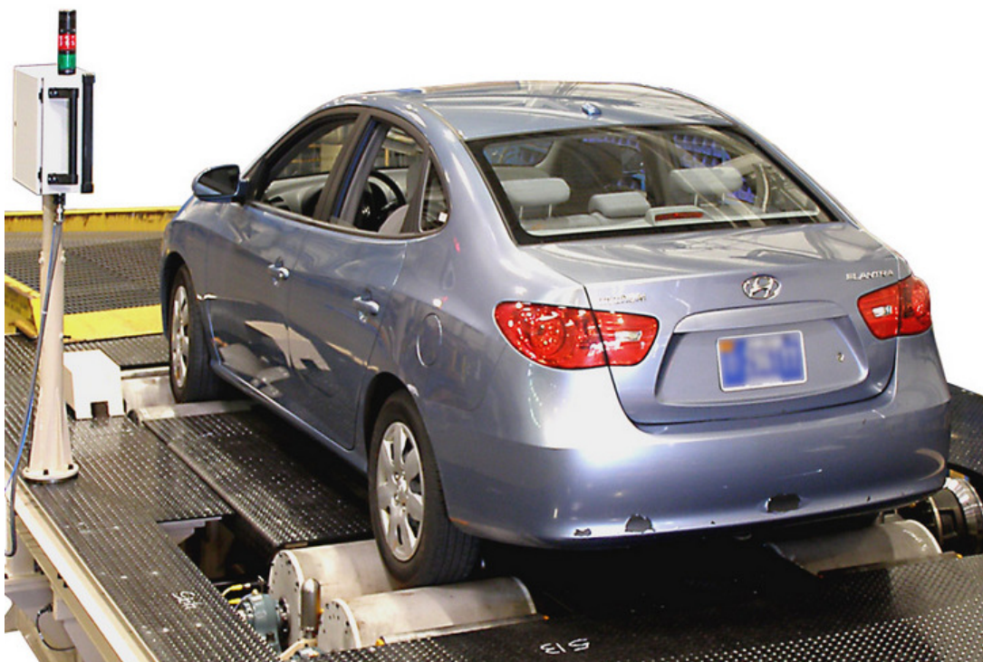
Figura 51 – Verificação funcional utilizando dinamômetro de rolo
