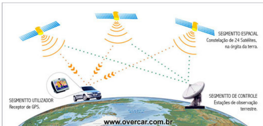
Figura 10 - Sistema de triangulação utilizado pelo sistema de navegação
