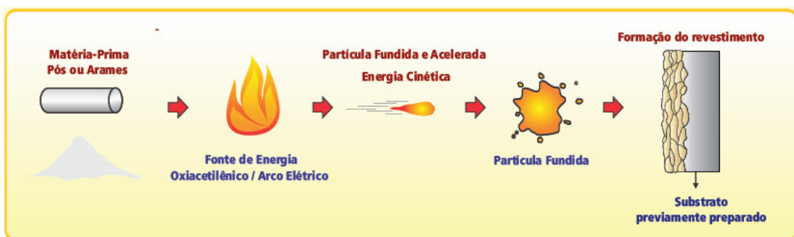
Figura 9 – Esquema simplificado da aplicação com ligas micropulverizadas
