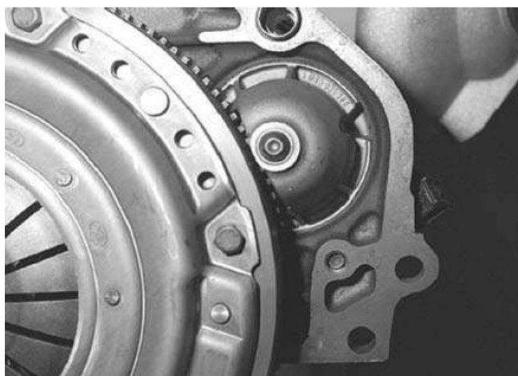
Figura 23: Foto do sistema de acoplamento com o motor
