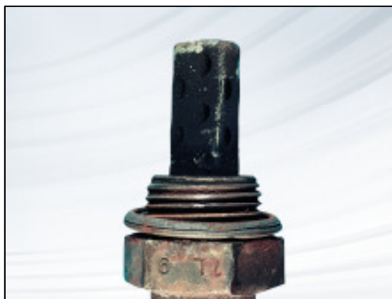
Figura 35 – Contaminação por depósito de carbono. (Fonte: http://www.ngkeurope.com/en/technology-in-detail/lambda-sensors/diagnosis/defects/ )
