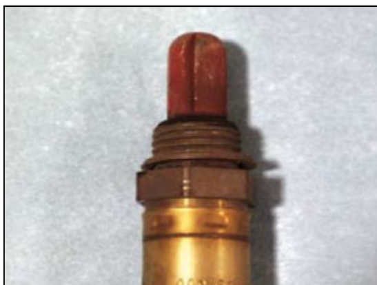
Figura 32 – Contaminação por combustível. (Fonte: http://www.boschautoparts.com/Technical%20Resources/Oxygen%20/O2SensorFaces.pdf )
