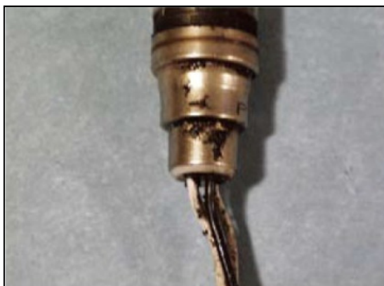
Figura 30 – Contaminação externa de óleo.
