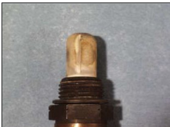
Figura 33 – Contaminação por combustível. (Fonte: http://www.boschautoparts.com/Technical%20Resources/Oxygen%20/O2SensorFaces.pdf )
