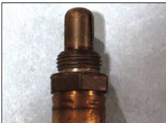
Figura 31 – Contaminação de óleo interna.
