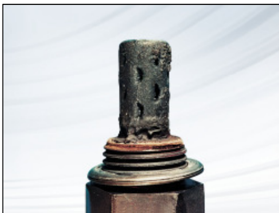
Figura 37 – Contaminação por aditivo. (Fonte: http://www.ngkeurope.com/en/technology-in-detail/lambda-sensors/diagnosis/defects/ )
