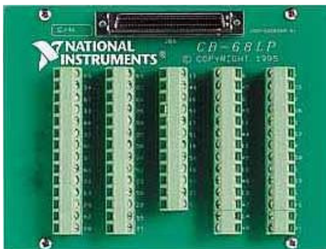
Figura 34 - Placa de conexões da NATIONAL INSTRUMENTS®.
