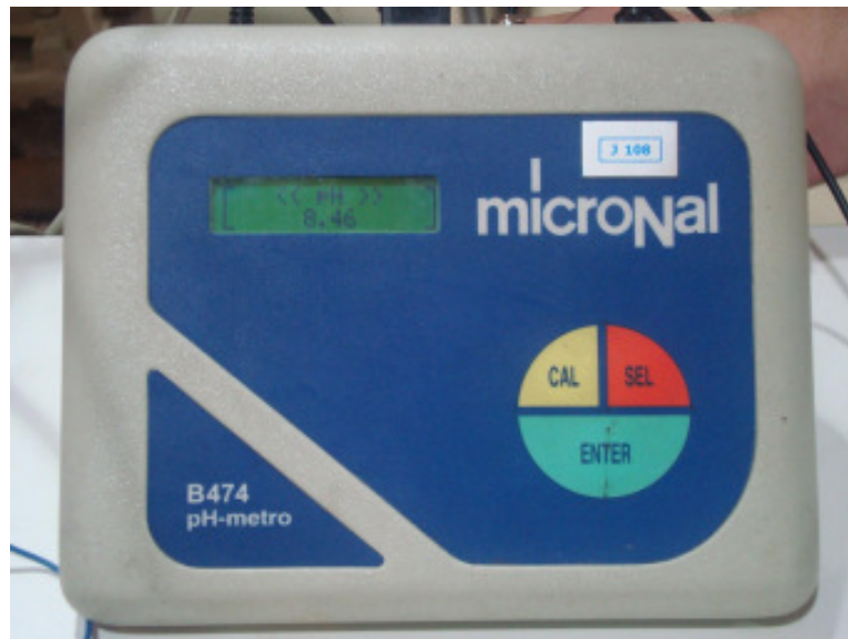
Figura 41 - Medidor de pH MICRONAL, modelo B-474 - phmetro
