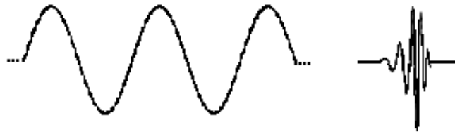
Figura 13 - Exemplo de comparação entre uma senóide e uma wavelet .
