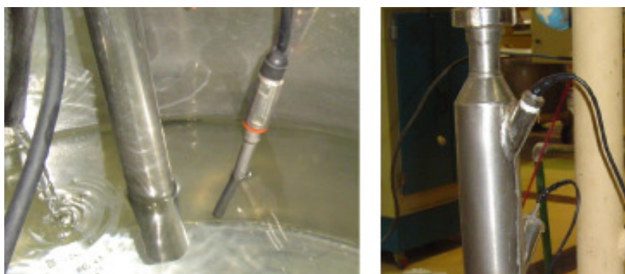
Figura 35 - Posicionamento dos elementos de medição de temperatura da entrada (T3) e saída (T1) do fluído de processo.
