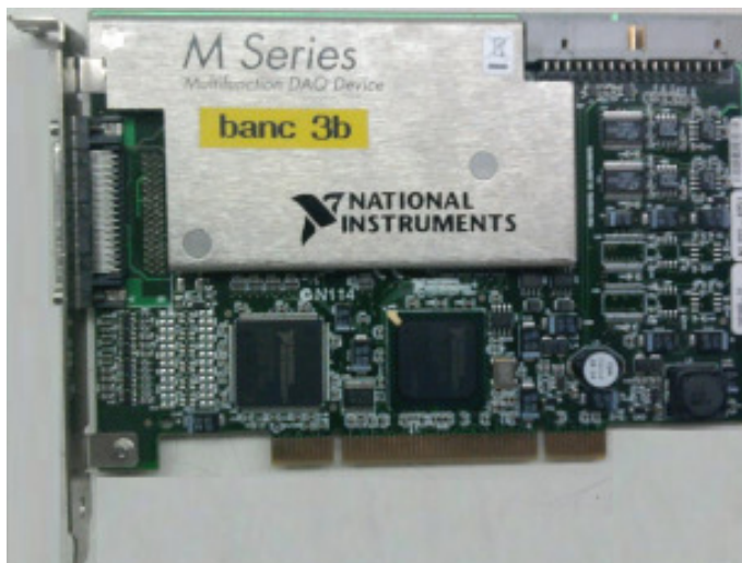
Figura 33 - Placa de aquisição de dados da NATIONAL INSTRUMENTS®.
