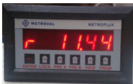
Figura 40 - Acoplador do sinal de vazão METROVAL modelo METROFLUX AG19.
