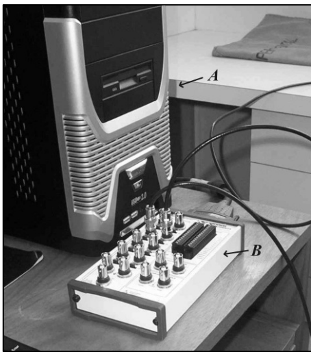
FIGURA 4.20 – HARDWARE DO SAD (A) Bloco conector BNC-2110, (B) Computador Pentium 4 com placa PCI-6036E
