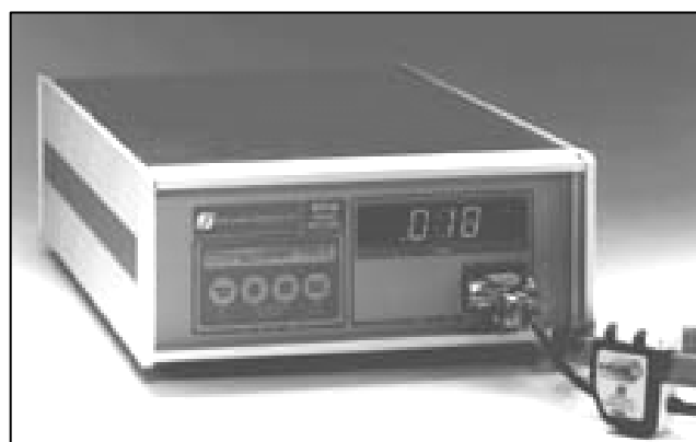
FIGURA 5.2 – MEDIDOR ULTRA-SÔNICO POR TEMPO DE TRÂNSITO, MODELO HT-110 DA TRANSONIC SYSTEMS INC
